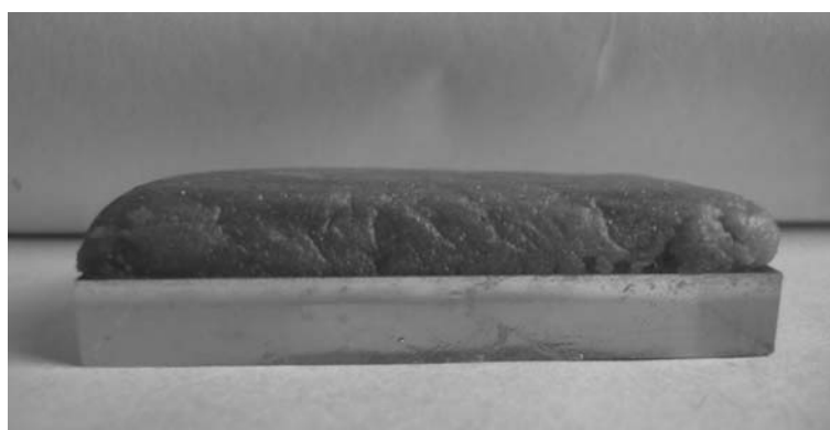
Рис. 1. Образец экспериментальной модели-фантома живой ткани.
