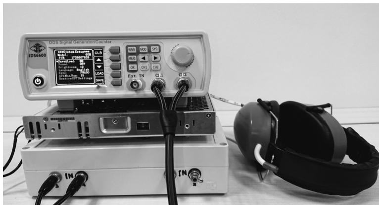
Рис. 2. Фото экспериментальной установки для электромагнитной стимуляции слуха
