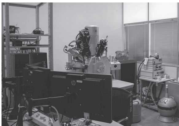
Рис. 11. Двухлучевой электронно-ионный микроскоп FEI Quanta 3D FEG Fig. 11. FEI Quanta 3D FEG dual beam electron and ion microscope
